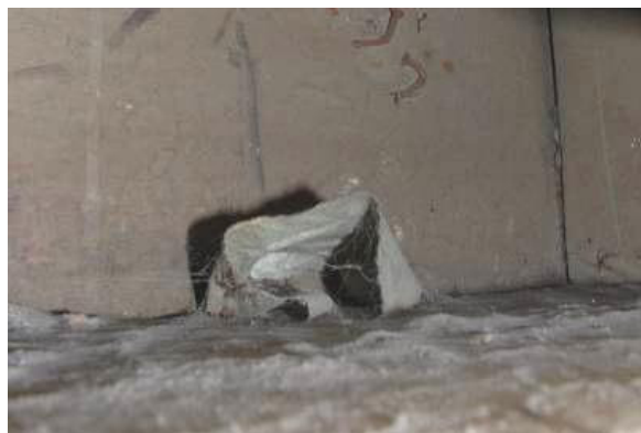
Figuras 22 y 23: toma de muestras puntuales y embalaje en tubos Eppendorf.
