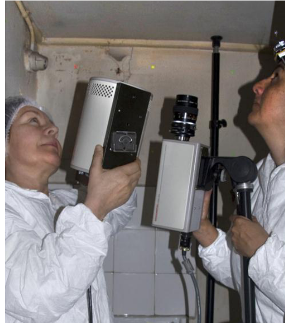
Figura 7: prospección con reflectografía IR en el cielo del baño 2, con cámara Vidicón Hamamatsu.
