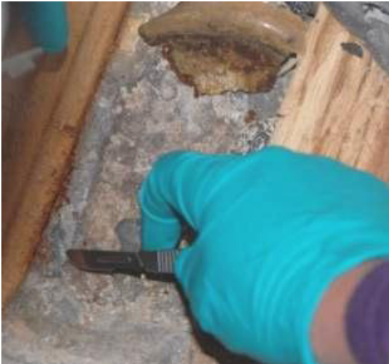
Figuras 22 y 23: toma de muestras puntuales y embalaje en tubos Eppendorf.
